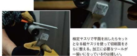
検定ヤスリで平面を出したらセットとなる組ヤスリを使って切断面をさらに整える。加工に必要なツールが一揃いになっているのは嬉しい。
