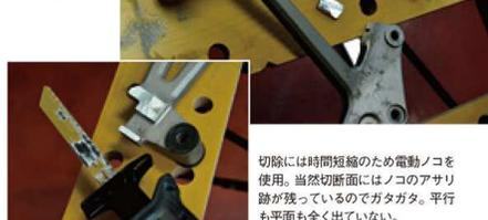
切除には時間短縮のため電動ノコを使用。当然切断面にはノコのアサリ跡が残っているのがガタガタ。平行も平面も全く出していない。
