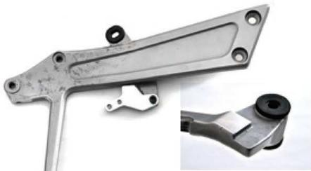
そもそも平面の出た定盤やストレートエッジを用いなかったので完璧な平面とは程遠いが、それでも切断面は十分に綺麗な平面となり違和感のない仕上がりとなった。念のため最後に研磨剤で磨いたが、ヤスリの細目だけでも十分に綺麗なヘアラインを作ることはできるだろう。
